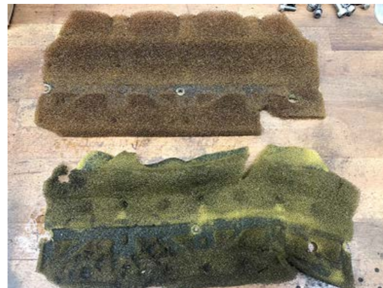
Schwamm oben: 3-4 Jahre alt bei jährlichem Ölwechsel.
