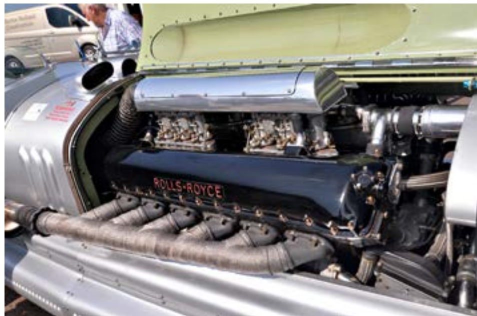
So etwas sieht man auch nicht alle Tage - ein 27 Liter Merlin Motor von Rolls Royce mit Weber-Vergasern
