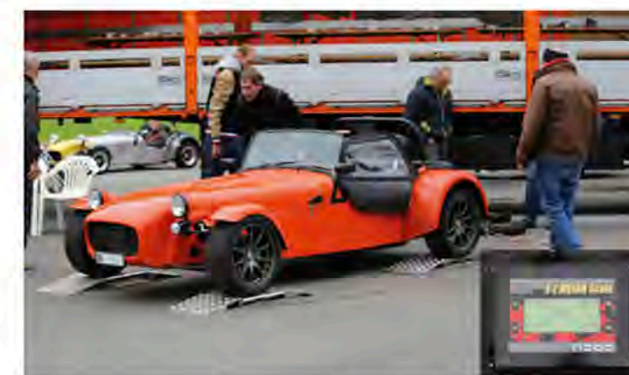
Messung der Radlasten.
