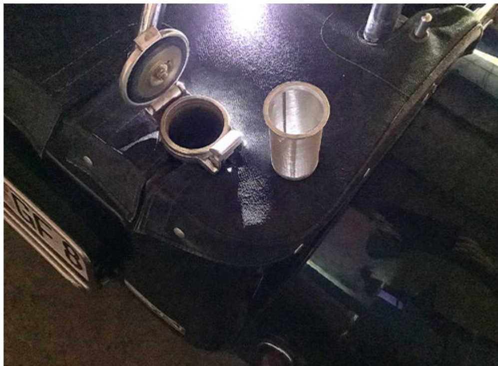
Der Tankstutzen und rechts daneben das Teesieb. The fuel cap and the tea strainer to the right.
