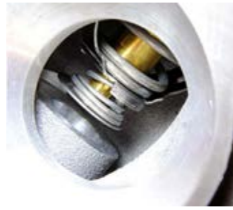
Der Thermostat steuert eine kontinuierliche Zirkulation der Kühlflüssigkeit um den Block - eine Mischung zwischen dem kühleren Kühler und dem heißeren Bypass-Kreislauf.
