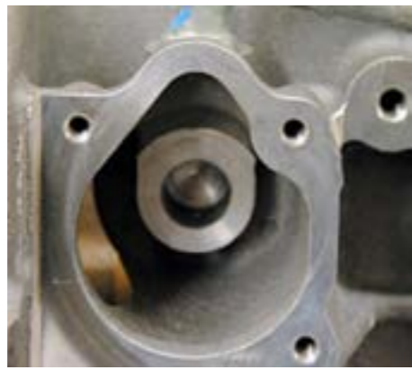
Der Thermostat steuert eine kontinuierliche Zirkulation der Kühlflüssigkeit um den Block - eine Mischung zwischen dem kühleren Kühler und dem heißeren Bypass-Kreislauf.
