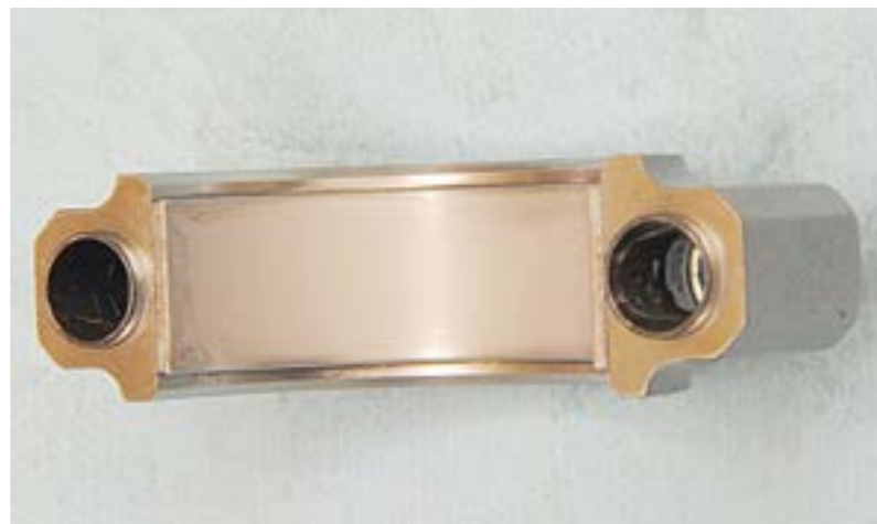
Untere Hälfte des Pleuels Lower half of the conrod
