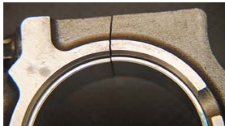
Die Pleuel werden in einem Stück gegossen und anschließend gebrochen und bearbeitet. Conrods are cast as one piece before being broken and then machined
