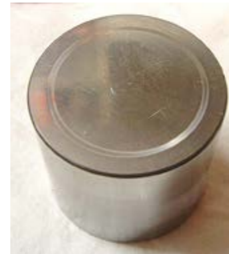
Tassenstößel haben ein hartes Leben. Nach dem Einlaufen des Motors sollten sie nicht mehr verstellt werden. Cam followers have a hard life. It's best not to change their position once the engine has run-in
