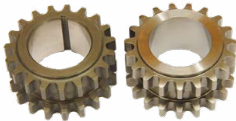
Ritzel mit Keilnuten können gekauft oder eingefräst werden Sprockets with keyways can be purchased, or be cut into the original item
