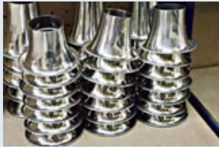
Oben: Die Gießereimodelle Darunter: Polierte Einlassstrichter Rechts: Die CNC-Bearbeitung
