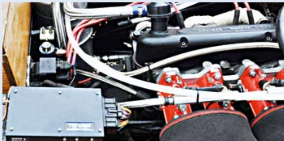
Modernes Gehirn, klassisches Herz - Andy's Couchman's Crossflow Seven mit Omex Steuergerät und Einzeldrosselklappen
